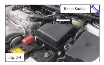
(d) Loosen the hose clamp at the neck of the air box (Fig. 2-4).
